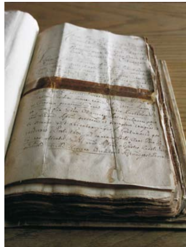
Książka ze zbiorów Biblioteki Kórnickiej. Taśma klejąca, użyta do sklejenia przedarcia osiemnastowiecznego rękopisu, spowodowała nieodwracalne zniszczenia. Syntetyczny klej przesycał papier, a następnie, w wyniku degradacji, doprowadził do silnego zbrązowienia i osłabienia karty. Sama taśma odkleiła się. Fot. Krystyna Olczyk
